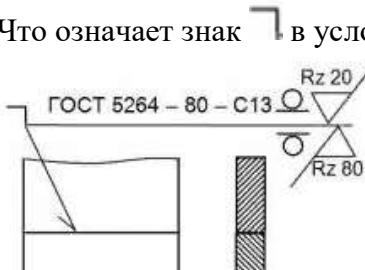
в условном обозначении сварного шва на чертеже?<br><br>
