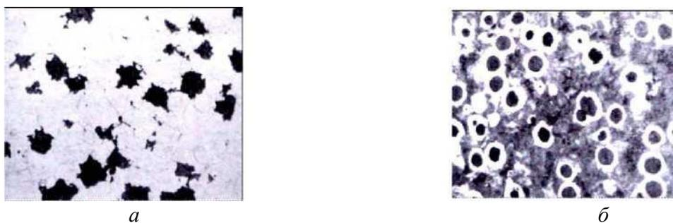
Рисунок 6. Микроструктура ферритного ковкого (а) и феррито-перлитного высокопрочного (б) чугунов
