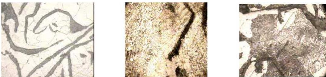
Рисунок 5. Микроструктура серого чугуна на различной металлической основе: а - ферритный; б - перлитный; в - феррито-перлитный
